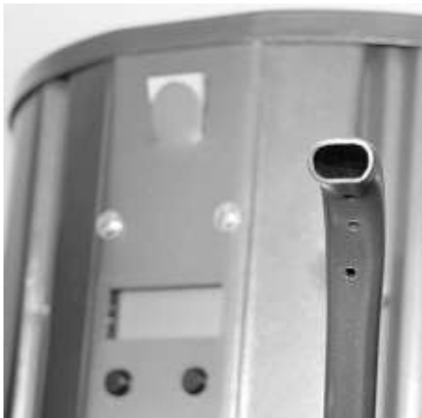
Fig. 3: ein Detail des Luftauslasses eines Luftdüsenarms
